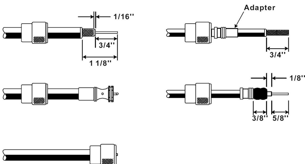
Для прокладки готового кабеля в помещениях корабля может потребоваться необходимость демонтажа разъема с последующей его установкой на кабель. От качества установки разъема будет зависеть качество работы всей радиосистемы корабля.
