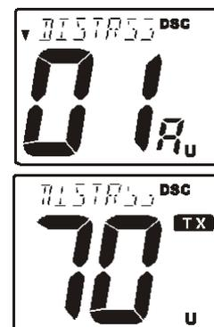
4. Радиостанция в "теневом" режиме прослушивает каналы **70** и **16**, пока не будет получен сигнал подтверждения приёма. На дисплее прокручивается: "**RECEIVED ACK**".
