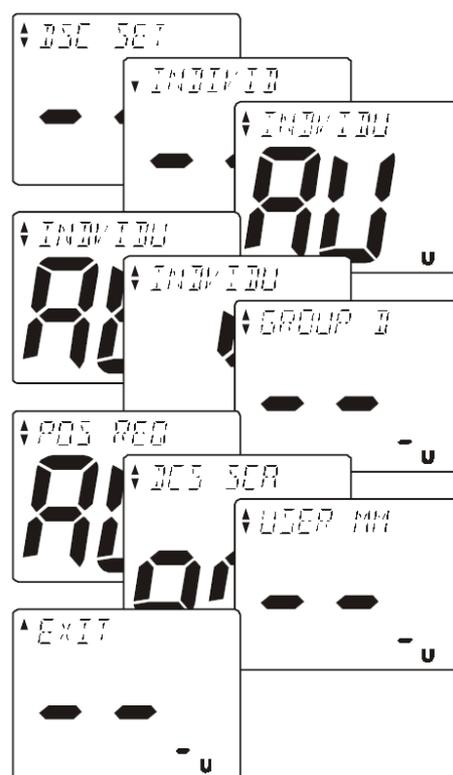
6. Для выхода из меню и перехода в рабочий режим радиостанции следует нажать клавиши «Стрелка вверх» и «Стрелка вниз» до появления на дисплее надписи EXIT и для завершения операции нажмите клавишу [CALL/SET].
