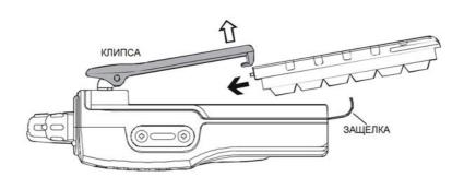
■ Для удаления батареи, выключите радиостанцию и снимите защитный чехол. Откройте замок батареи, затем нажмите на верхнюю часть клипсы, поднимите нижнюю часть батареи и удалите ее из радиостанции.
