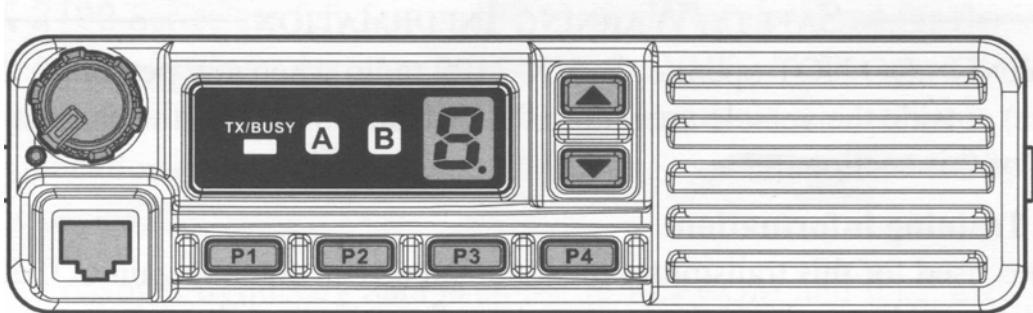
**VX-2100** — это полнофункциональная FM радиостанция, предназначенная для связи в мобильном и базовом вариантах в диапазонах VHF или UHF.
