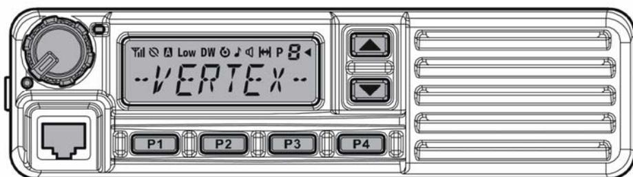
**VX-2200** — это полнофункциональная FM радиостанция, предназначенная для связи в мобильном и базовом вариантах в диапазонах VHF или UHF. Радиостанция имеет память на 128 каналов, каждый из которых может иметь свое имя из 8-ми символов.
