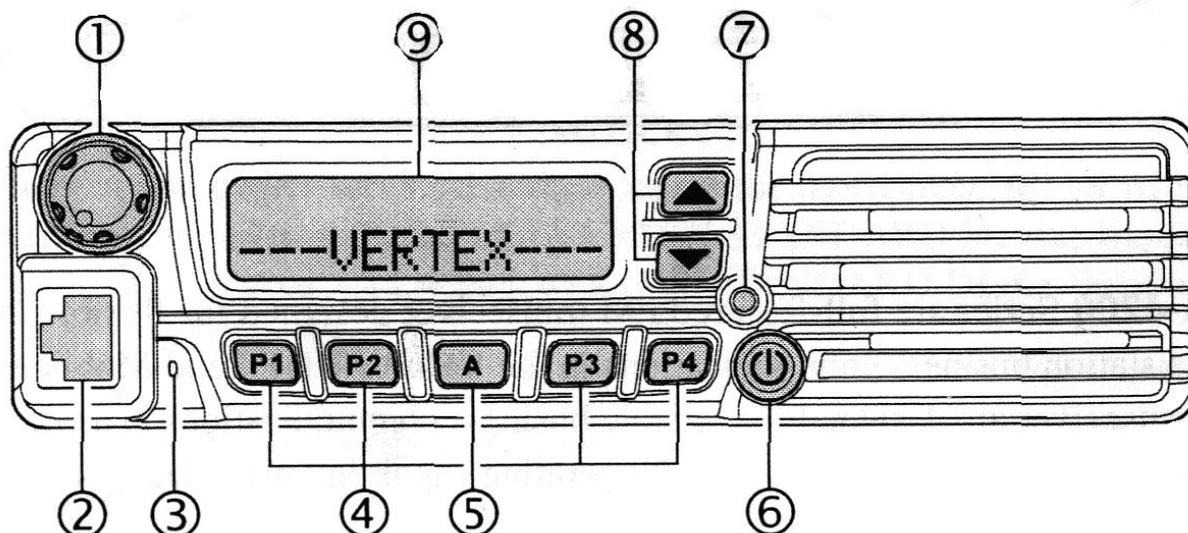
**Важно:** Все кнопки, находящиеся на передней панели, являются программируемыми, то есть программируются дилером VERTEX STANDARD согласно рабочим требованиям. В данной инструкции описана радиостанция, сконфигурированная типичным образом.
