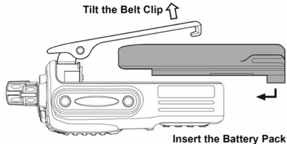
■ Для удаления батареи, выключите радиостанцию и снимите защитный чехол. Откройте замок батареи, затем нажмите на верхнюю часть клипсы, поднимите нижнюю часть батареи и удалите ее из радиостанции.
