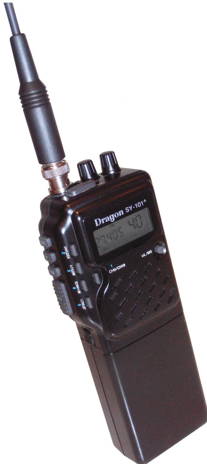
Портативная радиостанция **Dragon SY-101+** предназначена для эксплуатации в гражданском диапазоне 27 МГц.
