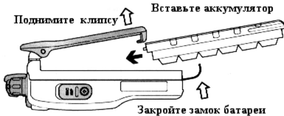
■ Для удаления батареи, выключите радиостанцию и снимите защитный чехол. Откройте замок батареи, затем нажмите на верхнюю часть клипсы, сдвиньте батарею назад и удалите ее из радиостанции.
