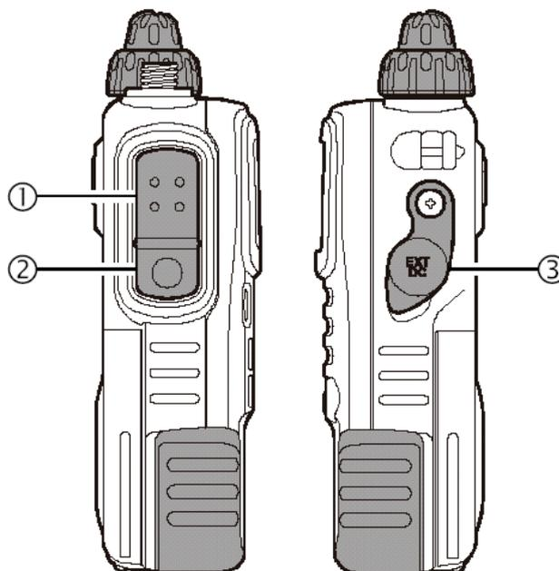
**Никогда не подключайте радиостанцию через этот разъем напрямую к бортовому источнику 28В.** Подключение через этот разъем источника питания с напряжением более 15В DC приведет к поломке радиостанции.
